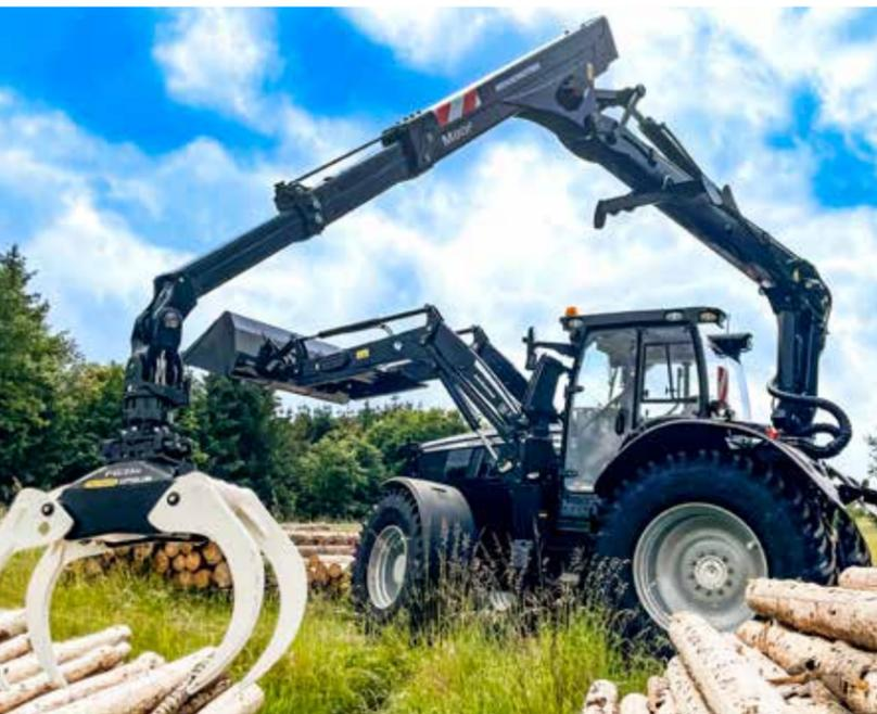
Der Kotschenreuther Systemschlepper ist ein sehr vielseitig einsetzbares Trägerfahrzeug und auf höchste Zuverlässigkeit, Fahrerkomfort und einfache Wartung konzipiert. Eine geräumige Fahrerkabine mit 360° drehbarem Fahrersitz und multifunktionaler Bedienung sorgt für bequemste Arbeitsbedingungen an langen Arbeitstagen. Dank der Schnellwechsellvorrichtungen können Arbeitsgeräte gewechselt werden und gewähren eine hohe Leistung und eine Steigerung der Produktivität.
