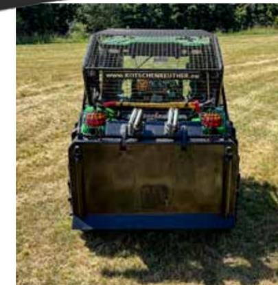
Die fest verbaute Krpan 8,5DH Doppel-trommel Konstantzugwinde mit 8,5 Tonnen Zugkraft in jeder Seillage und einer Bremskraft von rund 10,5 Tonnen beid-seitig, lässt keine Wünsche offen.
