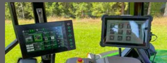
Große Auswahl an Mess- und Steuerungseinrichtungen für den Harvesterkopf.
