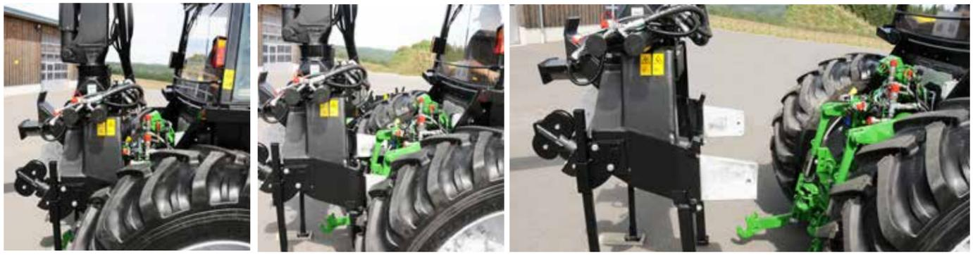
Durch das optionale Schnellwechselsystem kann der Kran in ca.15 Minuten abgebaut werden.
