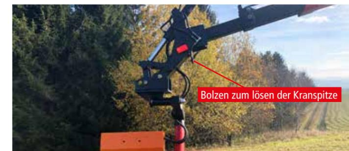
Bolzen zum lösen der Kranspitze
