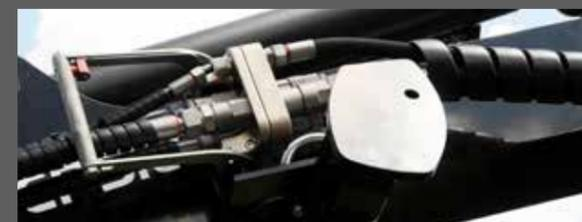
Multikuppler, für eine schnelle und saubere Trennung der Versorgungsschläuche. Der Abbau des Schlauchsystems zum Umbau vom Harvesterkopf auf Rückgreifer beträgt so nur ca. 10-15 Minuten.
