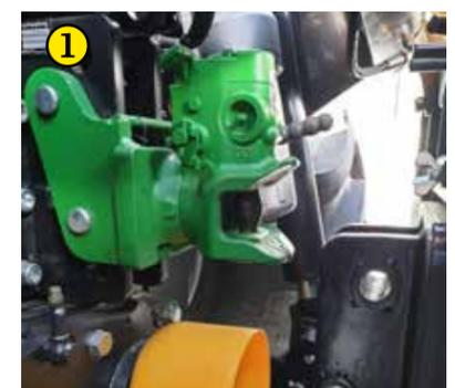
1 Automatische Anhängerkupplung (38 mm), befestigt mit zwei Bolzen an Fahrzeugkonsole.
