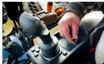
Hydraulische Zusatzsteuergeräte in Armlehne griffgünstig bedienbar
