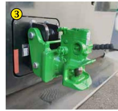
3 Anhängerkupplung am drehbaren Adapter der Rückwand befestigt, mit StVZO Zulassung.
