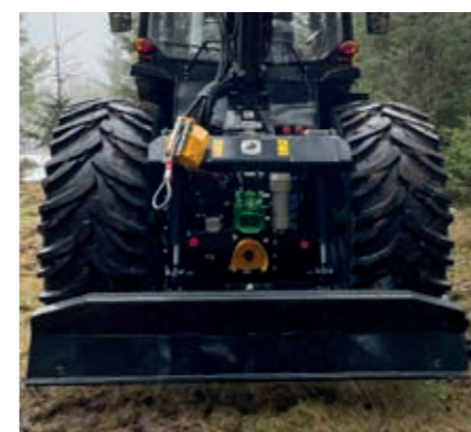
NIEDRIGES RÜCKESCHILD Mit nur ca. 40 cm Höhe kann die Anhängerkupplung und Zapfelle des Schleppers jederzeit genutzt werden.
