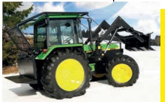
John Deere 2850 mit Doppeltrommelwinde und Frontpolterschwinge
