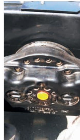
Bogieachse NAF mit hydraulischem Antrieb
