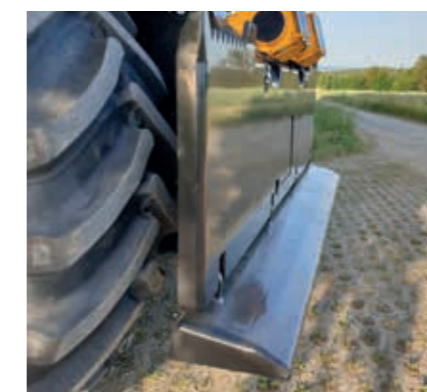
GERADES RÜCKESCHILD Durch das gerade Rückeschild wird ein problemloses Anhängen gewährleistet.
