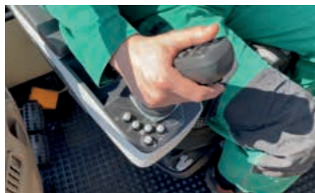
Die gepolsterten Armlehnen sind in der Höhe, der Länge, der Neigung und der Breite verstellbar
