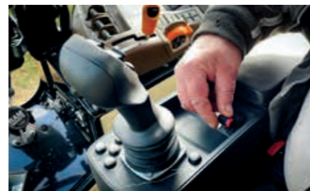
Hydraulische Zusatzsteuergeräte in Armlehne griffgünstig bedienbar
