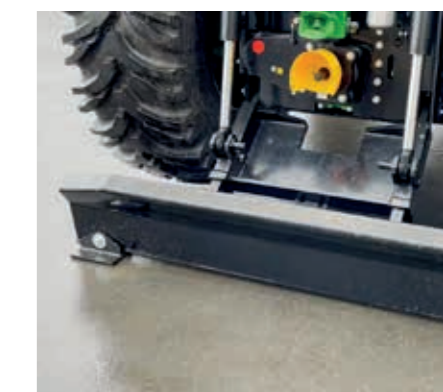
SCHUTZKUFEN Optimal geeignet für den Einsatz bei Straßensicherungsmaßnahmen. (Asphaltschutz)
