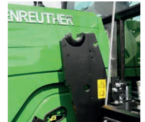
Frontladerkonsolen im Schnellver- schluß mit Multikuppler
