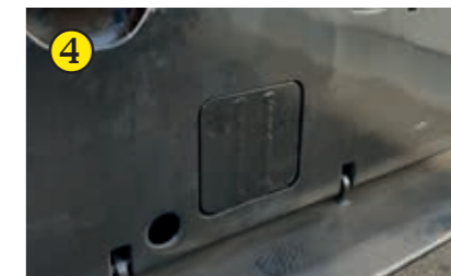
4 Adapter in Richtung Schlepper gedreht, die glatte Rückwand ist nun wieder voll nutzbar für Rückarbeiten.
