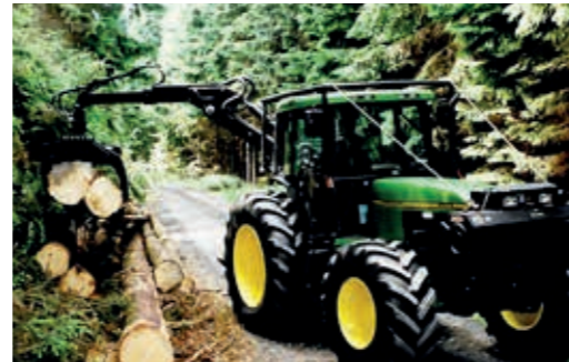
John Deere 6506 mit Rückekran, Winde und Schutzausrüstung
