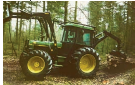
John Deere 2850 mit Rückekran und Frontpolterschwinge
