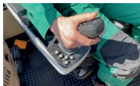
Les accoudoirs rembourrés sont réglables en hauteur, longueur, inclinaison et largeur
