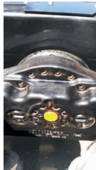
Essieu boggie NAF à entraînement hydraulique
