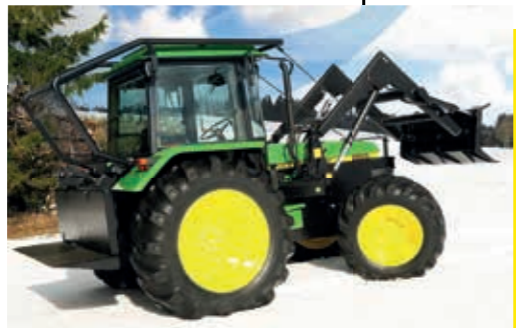
John Deere 2850 avec treuil à double tambour et bras avant
