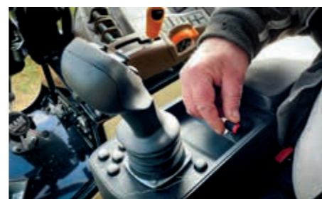
Distributeurs auxiliaires hydrauliques faciles d'accès dans l'accoudoir
