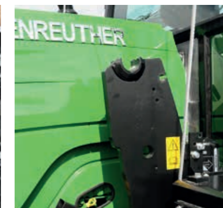
Consoles de relevage avant à fixation rapide avec coupleur multiple
