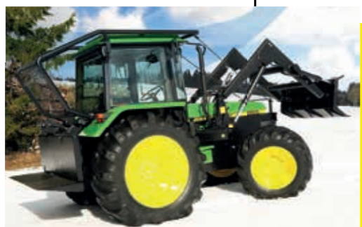
John Deere 2850 z podwójną wciągarką bębnową i przednim wahaczem do drewna stosowego
