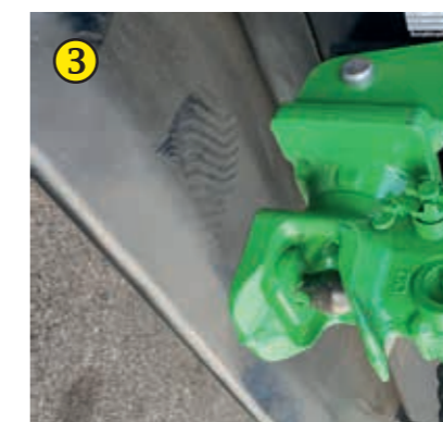
3 Zaczepek przyczepek mocowany do obrotowego adaptera na tylnej ścianie, z dopuszczeniem StVZO.
