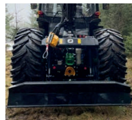
2 Obrotowy adapter do haka holowniczego w tylnej ścianie - w kilka minut możesz podczepić przyczepek do tylnej ściany.
