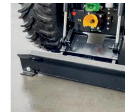
4 Adapter obrócony w kierunku ciągnika, gładka ściana tylna może być teraz w pełni wykorzystana do prac zrywkowych.
