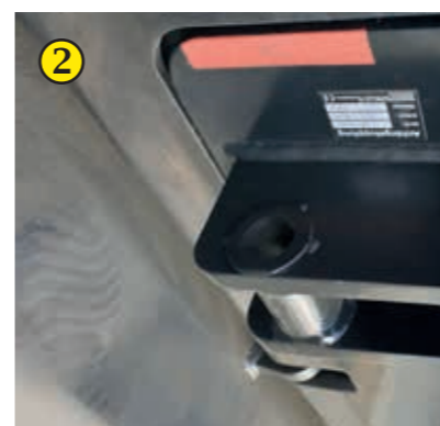
2 Obrotowy adapter do haka holowniczego w tylnej ścianie - w kilka minut możesz podczepić przyczepek do tylnej ściany.
