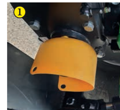
1 Automatyczny zaczepek przyczepek (38 mm) mocowany do konsoli pojazdu za pomocą dwóch sworzni.
